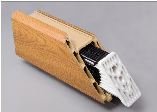
1. Eckschweißverbinder (141.525) in die Verstärkung des Profils einschieben und ausrichten (verschweißbare Fläche muss leicht zurück liegen).
